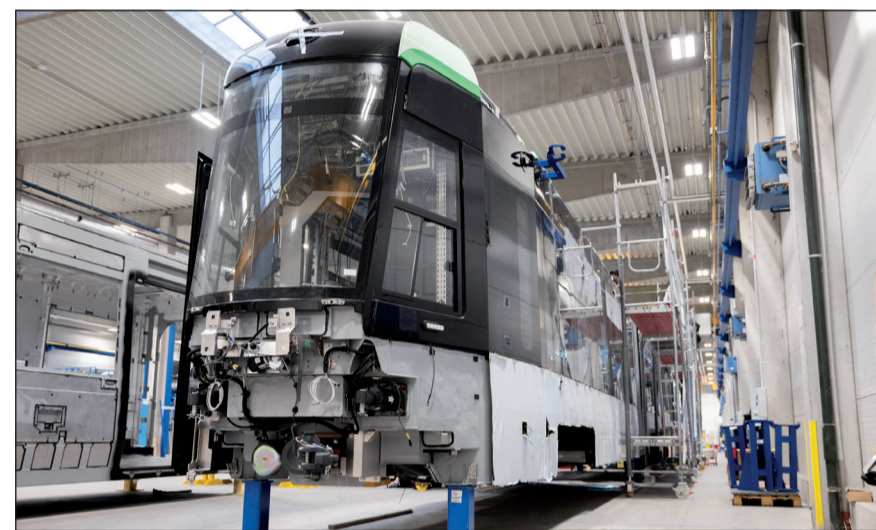
Rohbau der neuen Straßenbahn.
